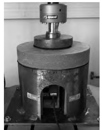
図2 新たに開発された処理済み土壌の疲労解析テスト装置
