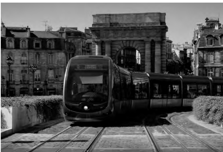
図7 ボルドーのシタディ(第三軌条方式)
