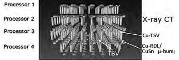
図4 3次元積層型プロセッサのSEM断面写真とCTスキャン像
